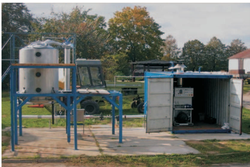
Fot. 1. Destylarnia konopnych olejków eterycznych w Zakładzie Doświadczalnym Pętkowo k. Środy Wlkp. Distiller for steam distillation of hemp essential oil in the Eksperimental Farm Pętkowo N/Środa Wlkp.
