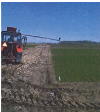
Fot. 3. Czujnik optyczny GreenSeeker RT 200 (NTech, USA) do pomiaru NDVI
