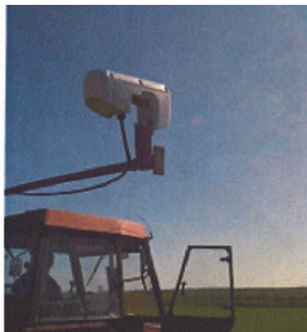
Fot. 3. Czujnik optyczny GreenSeeker RT 200 (NTech, USA) do pomiaru NDVI
