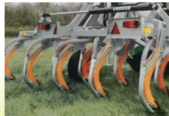
Aplikator doglebowy. Szerokość robocza 2,8 – 5,2 m Głębokość aplikacji : 10-12 cm źródło: http://www.joskin.com
