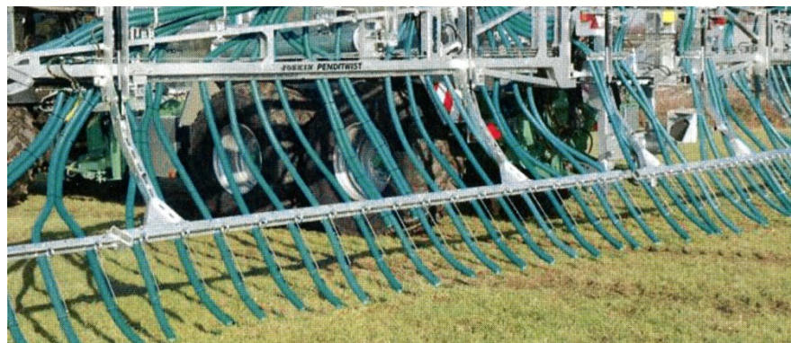
Rampa z węzami wleczonymi Szerokość robocza rozlewania 9-30 m. Odstęp między węzami: 25 lub 30 cm źródło: http://www.joskin.com
