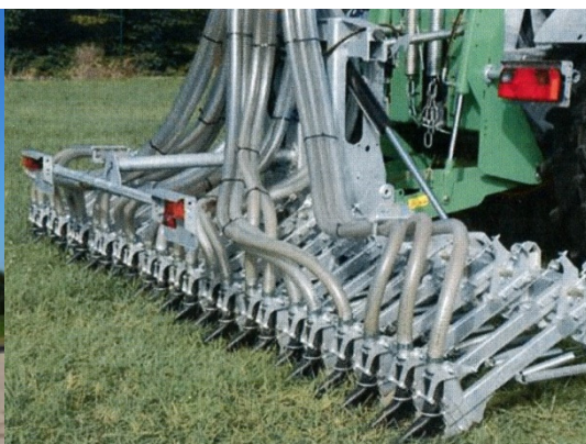
Aplikator do łąk. Szerokość aplikacji 3- 7,7 . Głębokość aplikacji 0-3 cm źródło: http://www.joskin.com
