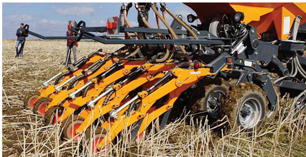
Fot. 5. Widok agregatu siewnego do uprawy pasowej (J. Kozyra)
