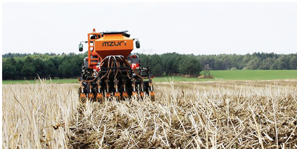
Fot. 4. Gleba po przejeździe agregatu siewnego do uprawy pasowej (J. Kozyra)
