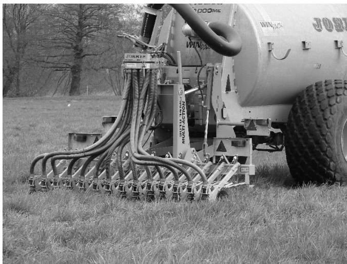
Fot. 1. Wóz asenizacyjny z aplikatorem do płytkiego wtryskiwania płynnych nawozów naturalnych (system firmy Joskin) (fot. P. Nawalany)
