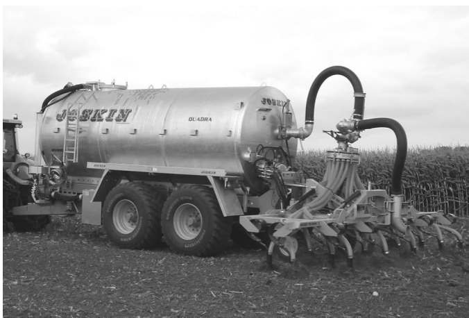
Fot. 2. Wóz asenizacyjny z aplikatorem do głębokiego wtryskiwania płynnych nawozów naturalnych (system firmy Joskin) [Materiały...]
