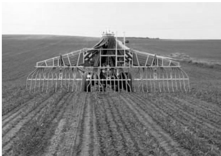
Fot. 3. Rozlewanie gnojowicy za pomocą wozu asenizacyjnego z przystawką z węzami wleczonymi (system firmy Zunhammer) [ZBYTEK, ŁOWIŃSKI, 2008]
