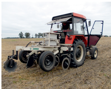
Fot. 4. Pomiar właściwości spektralnych gleb systemem Veris (spektrofotometr VIS-NIR) Veris Technologies, Inc. 601 N. Broadway Salina KS 67401
