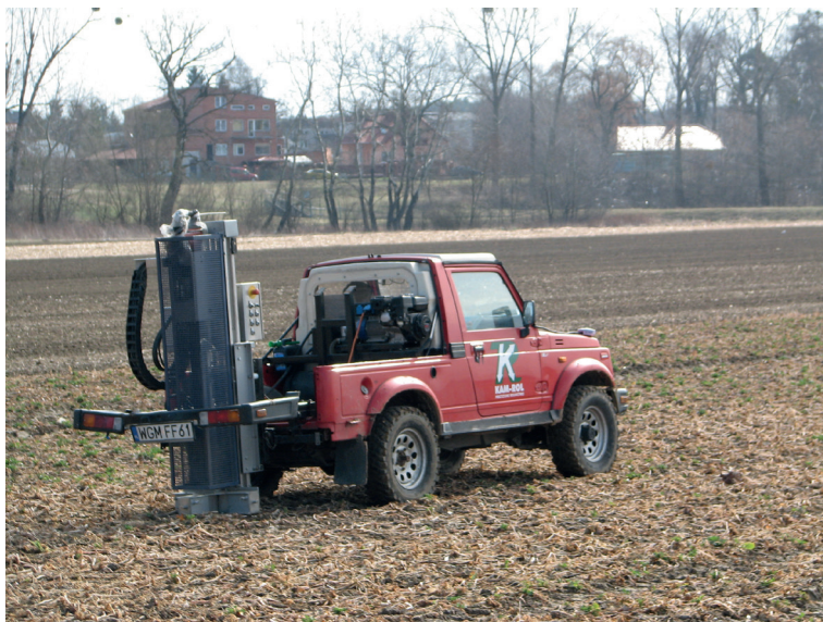
Fot. 2. Pobieranie próbek glebowych przy pomocy próbnika pneumatycznego
