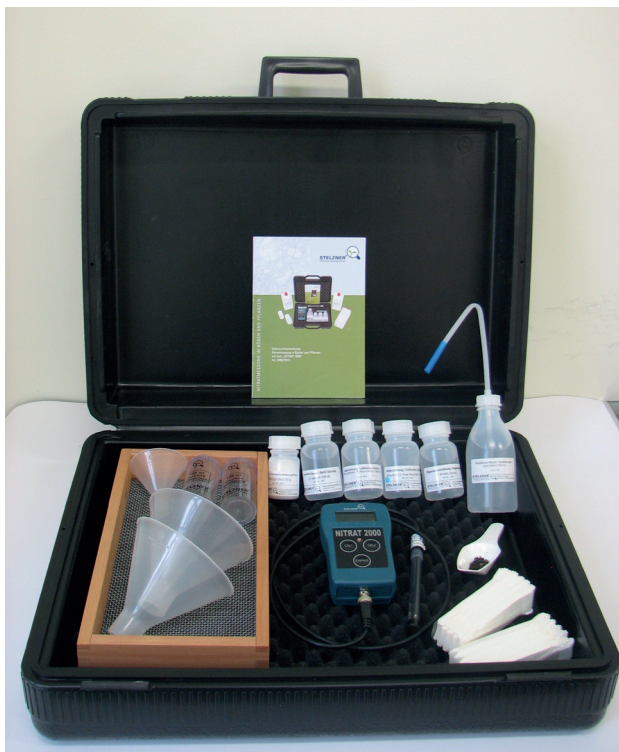
Fot. 3. Zestaw do pomiaru aktywności jonów azotanowych w glebie
