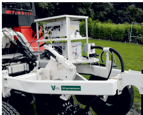
Fot. 4. Pomiar właściwości spektralnych gleb systemem Veris (spektrofotometr VIS-NIR) Veris Technologies, Inc. 601 N. Broadway Salina KS 67401
