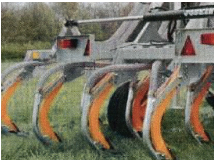
Fot. 9. Aplikator doglebowy. Szerokość robocza 2,8-5,2 m; zalecana głębokość robocza: 10-12 cm
