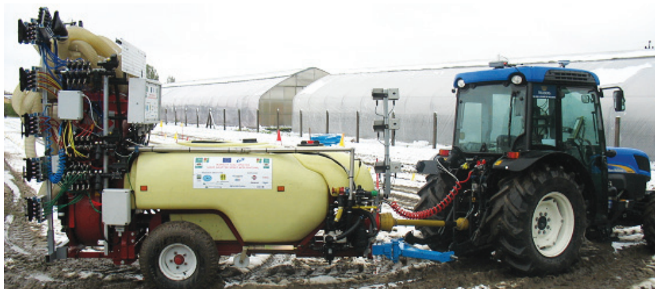
Rysunek 12. Ogólny widok prototypu inteligentnego opryskiwacza sadowniczego CASA Źródło: opracowanie własne
