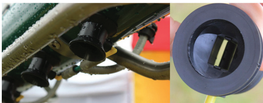
Rysunek 6. Rozpylacze pneumatyczne Eurofoil zbudowane są z dyfuzora i płytkowego dozownika Źródło: https://www.farmer.pl , 2019 (26)
