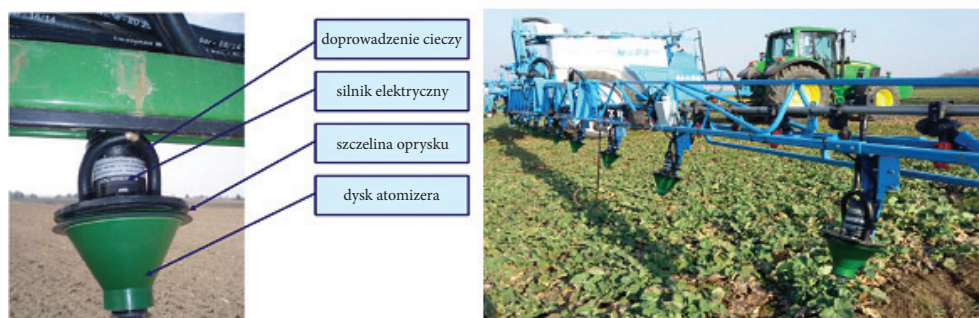
Rysunek 7. Rozpylacz rotacyjny Micromax i zmodernizowany z jego użyciem opryskiwacz polowy Źródło: Micro-system, 2016 (32)
