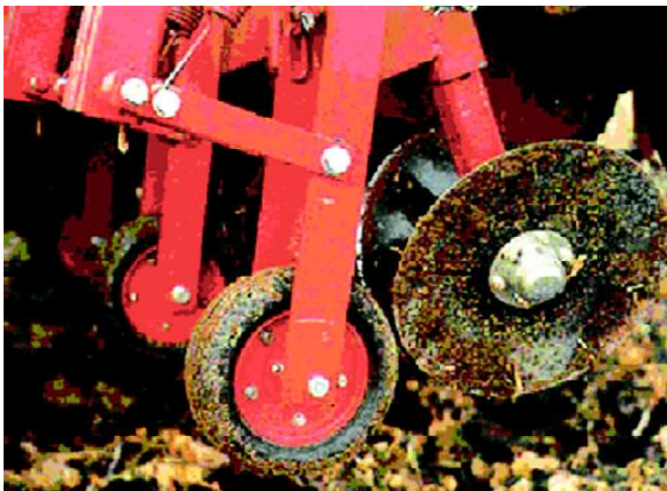
Rys. 3. Tarcze rozgarniające warstwę słomy w siewnikach do uprawy bezpłużnej Źródło: Kreitmayr J., Beckmann Ch., 2004 (14).
