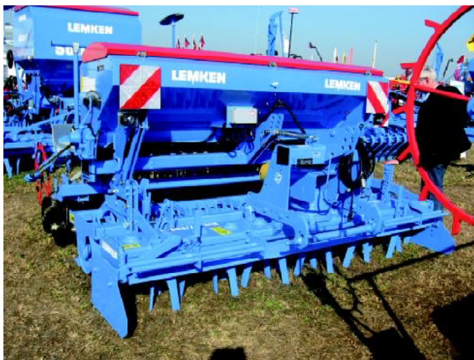
Rys. 4. Siewnik uniwersalny wyposażony w redlice talerzowe i bronę wirnikową Źródło: Kreitmayr J., Beckmann Ch., 2004 (14).
