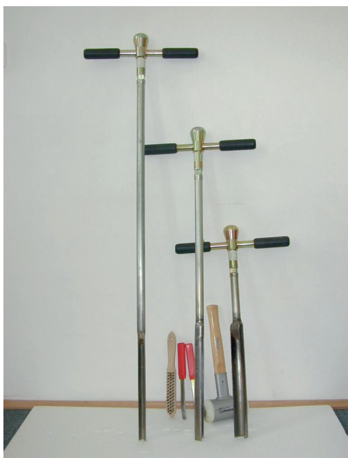
Fot. 1. Przykładowe laski glebowe do pobierania próbek do głębokości 90 cm
