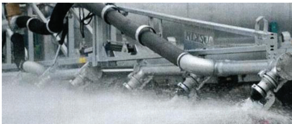
Fot. 6. Rampa rozlewająca wielodyszowa
