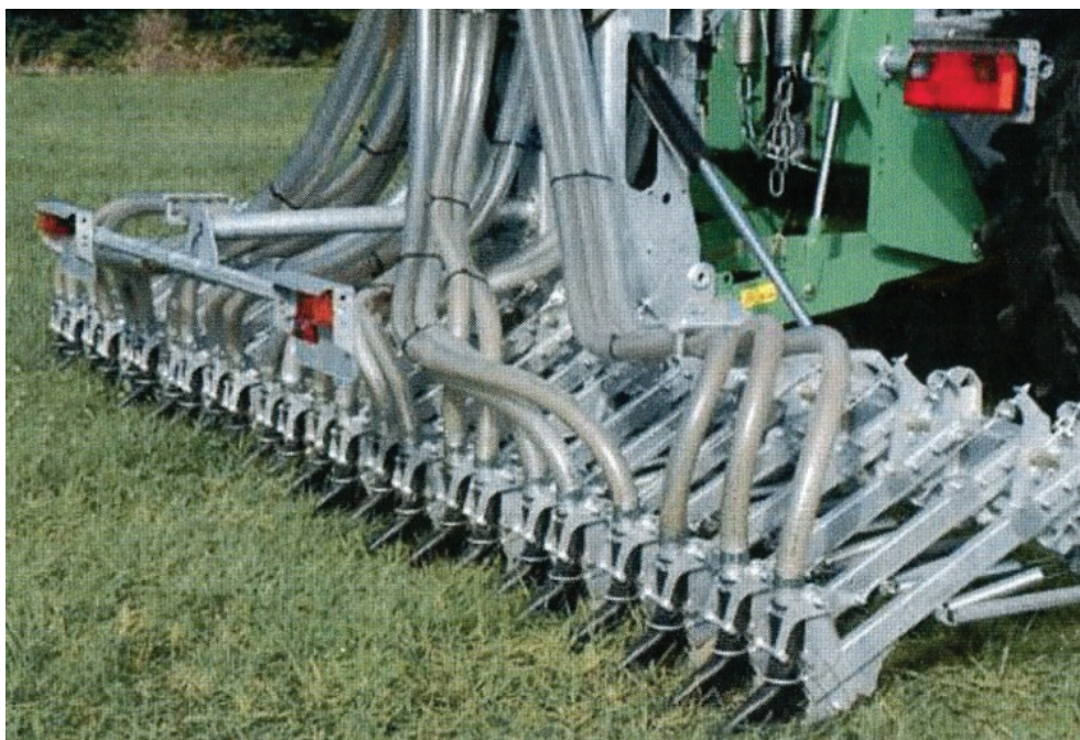
Fot. 8. Aplikator do łąk. Szerokość aplikacja 3- 7,7 m; zalecana głębokość robocza: 0-3 cm
