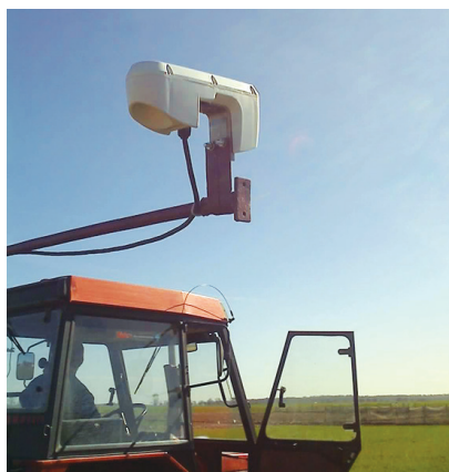
Rys. 7. GreenSeeker umieszczony na dachu ciągnika
