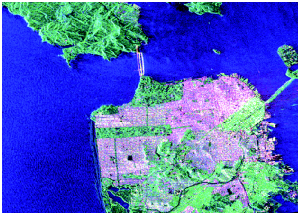
Rys. 9. Zobrazowanie z satelity RADARSAT-2 wykonane w poczwórnej polaryzacji i rozdzielczości 10 m; San Francisco, USA
