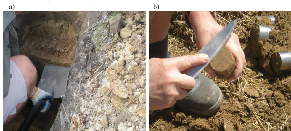
Fot. 2. Wkopywanie cylinderków: a) do oznaczeń gęstości objętościowej gleb z różnych warstw profilu glebowego i b) procedura oczyszczania cylinderków w polu do oznaczeń gęstości objętościowej gleb
