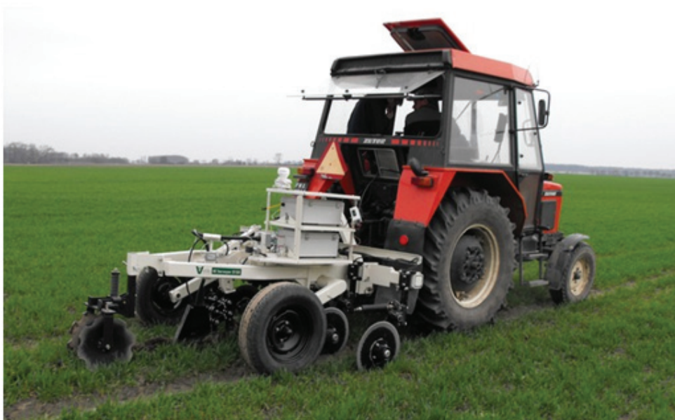
Fot. 1. Pomiar „on-the-go” właściwości spektralnych gleb mobilnym spektrofotometrem (VerisTech. USA)
