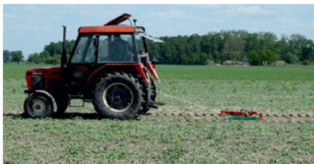
Fot. 3. Pomiar przewodności elektrycznej konduktometrem EM 38 MK2 (fot. J. Niedźwiecki)
