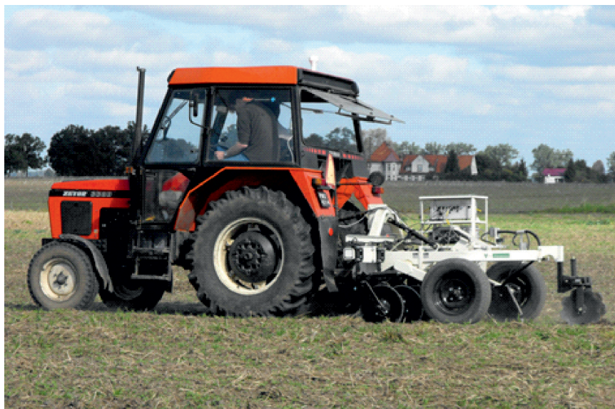
Fot. 4. Pomiar właściwości spektralnych gleb systemem Veris (fot. J. Niedźwiecki)
