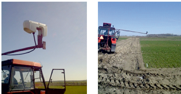
Fot. 6. Czujnik optyczny GreenSeeker RT 200 (NTech, USA) podczas pomiarów (fot. J. Niedźwiecki)
