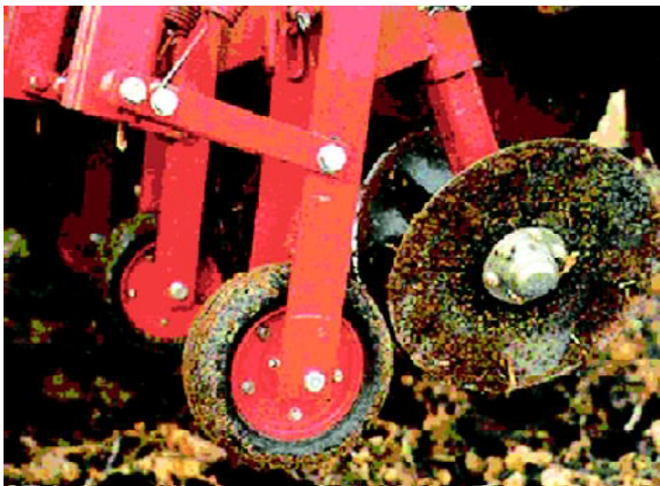
Rys. 3. Tarcze rozgarniające warstwę słomy w siewnikach do uprawy bezpłaznej Źródło: Kreitmayr J., Beckmann Ch., 2004 (14).
