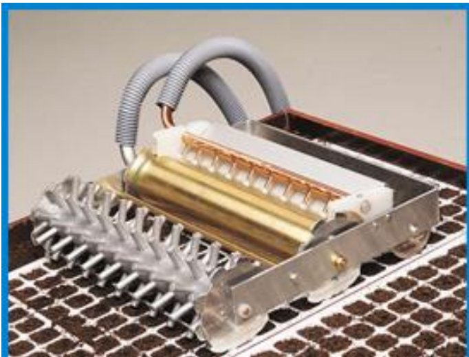
Siew nasion otoczkowanych z użyciem stacji wyposażonej w siewnik
