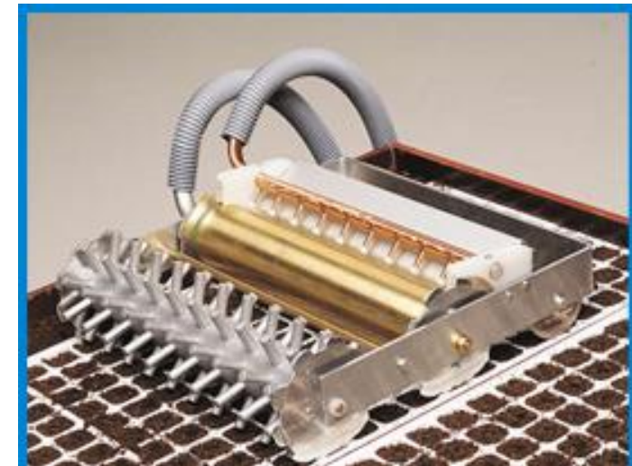
Stacja załadowcza wyposażona w siewnik pneumatyczny
