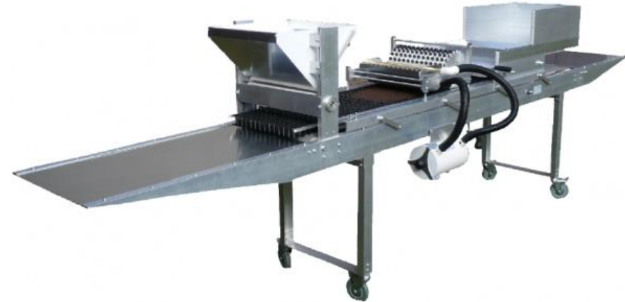
Stacja załadowcza wyposażona w siewnik pneumatyczny
